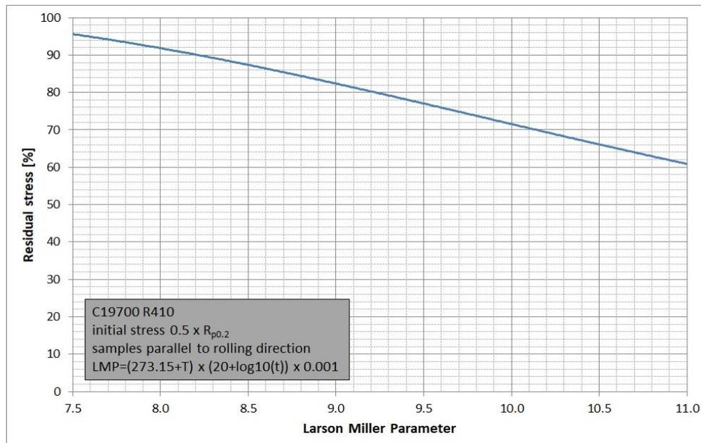
Die Relaxationsdaten werden als Restspannung über den Larson Miller Parameter aufgetragen. Der Larson Miller Parameter repräsentiert die Vergleichstemperatur und Testdauer. Test Methode: Mandrel Test entsprechend ASTM E328.
