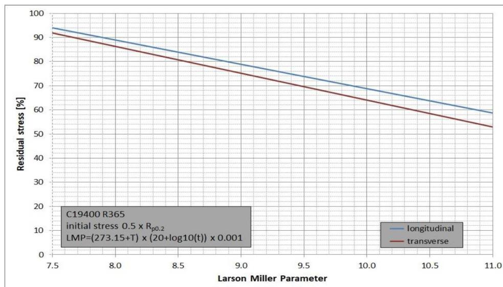
Die Relaxationsdaten werden als Restspannung über den Larson Miller Parameter aufgetragen. Der Larson Miller Parameter repräsentiert die Vergleichstemperatur und Testdauer. Test Methode: Mandrel Test entsprechend ASTM E328.
